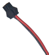
Dettaglio del connettore della batteria
